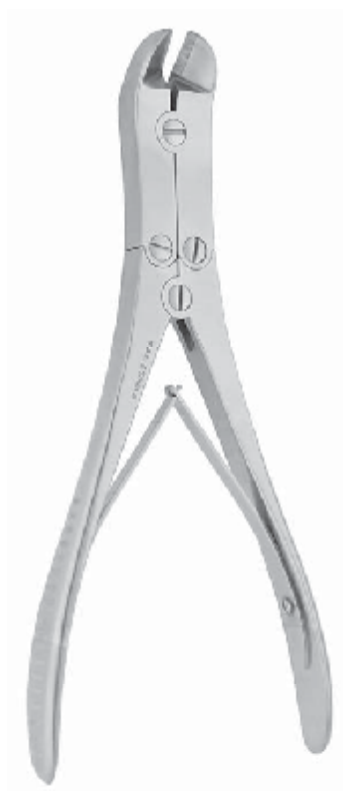
7-434 Wire Cutter 220 mm TC soft wire 3.0 mm hard wire 2.5 mm Drahtschneidezange 220 TC für weichen Draht bis \varnothing 2,5 mm für harten Draht bis \varnothing 3,0 mm
